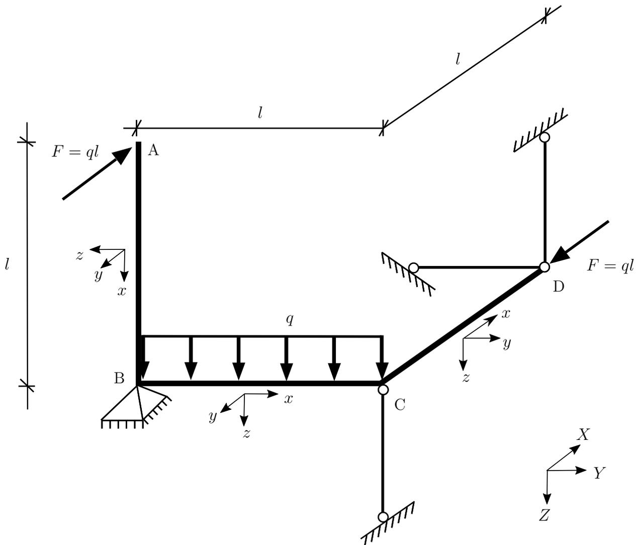
Das perspektivisch dargestellte, räumliche, rechtwinklige Tragwerk ist durch die konstante Streckenlast  $q$  und zwei Einzellasten  $F = ql$  belastet. Die Wirkungslinien der Einzellasten liegen parallel zur globalen  $X$ -Richtung. Die Streckenlast  $q$  wirkt in globaler  $Z$ -Richtung.
