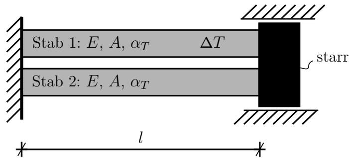
Zwei gleiche Stäbe (Ausgangslänge  $l$ , Querschnittsfläche  $A$ , Elastizitätsmodul  $E$ , Wärmeausdehnungskoeffizient  $\alpha_T$ ) sind an einer gemeinsamen starren Führung verbunden. Der Stab 1 wird um  $\Delta T$  erwärmt ( $\Delta T > 0$ ). Die Temperatur des zweiten Stabs ändert sich nicht.
