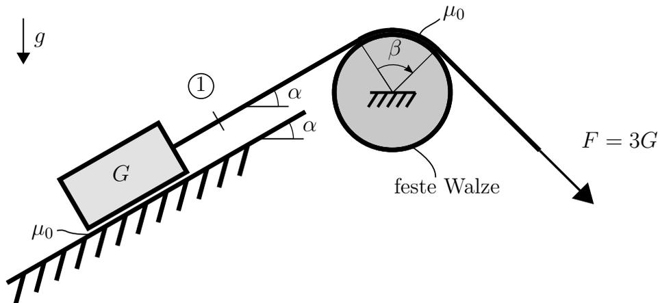
Ein masseloses Seil wird über eine feste, raue Walze (Haftungskoeffizient  $\mu_0$ ) geführt. Am rechten Ende des Seils wird mit einer Kraft  $F$  gezogen. Am linken Ende des Seils ist als Gegengewicht eine Kiste mit dem Gewicht  $G$  befestigt, welche auf einer rauhen, schiefen Ebene (Neigungswinkel  $\alpha$ , Haftungskoeffizient  $\mu_0$ ) aufliegt.
