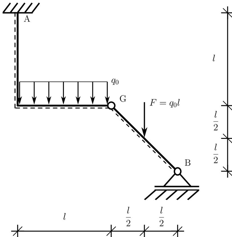
Der dargestellte Rahmen ist mit einer konstanten Streckenlast  $q_0$  und einer Einzelkraft  $F = q_0 l$  belastet.
